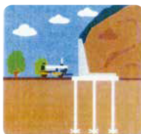
擁壁基礎・抑止杭
