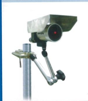
パイルレーザー
