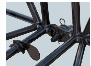
両テーパジョイントピン(ブーム下側)とストッパ ピンの打込み・打抜き作業がブームの外側から行えます。
